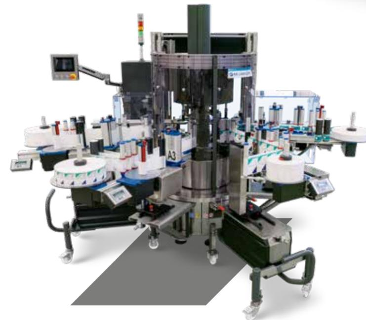
Machine configurée avec quatre stations autocollantes : deux installées sur péninsule fixe et deux sur chariot mobile.
