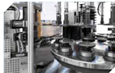
Réserve d'étiquettes et rouleau pour l'application de la colle sur la partie supérieure de l'étiquette.
