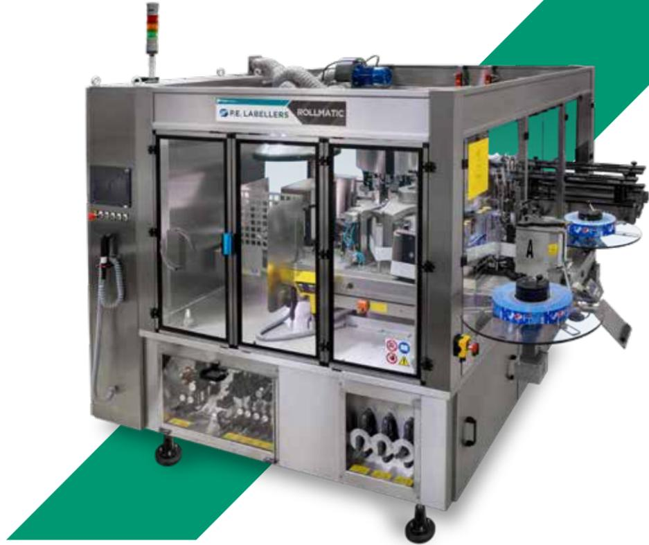
Rollmatic est une étiqueteuse rotative par bobine pour l'application d'étiquettes enveloppantes avec colle à chaud. Elle atteint les 60 000 BpH et elle est disponible en quatre dimensions.
