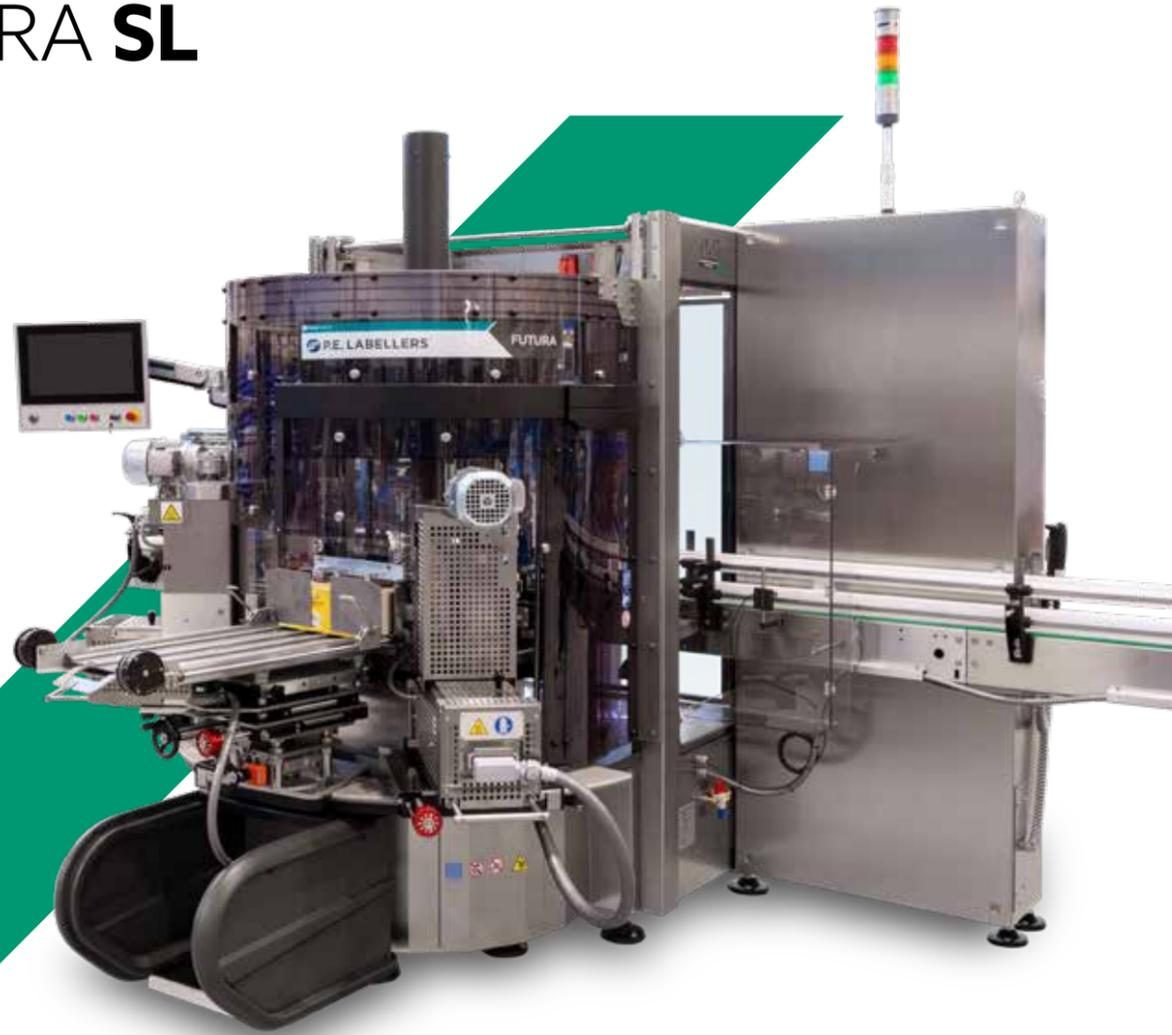
Futura SL est une solution avec technologie de colle à chaud pour l'application d'étiquettes enveloppantes prédécoupées en papier.
