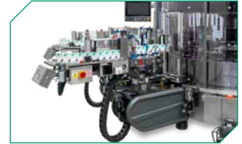
Stations d'étiquetage autocollante installée sur module fixe (SLB).
