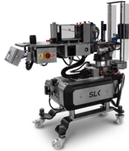
Station d'étiquetage autocollante pour applications d'étiquettes partielles, collerettes et sceaux.
